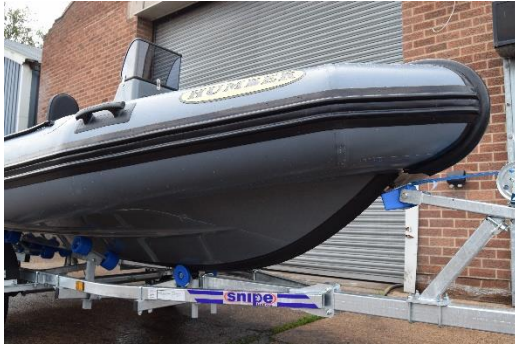
Mini double 'D' outer tube rubbing strake
